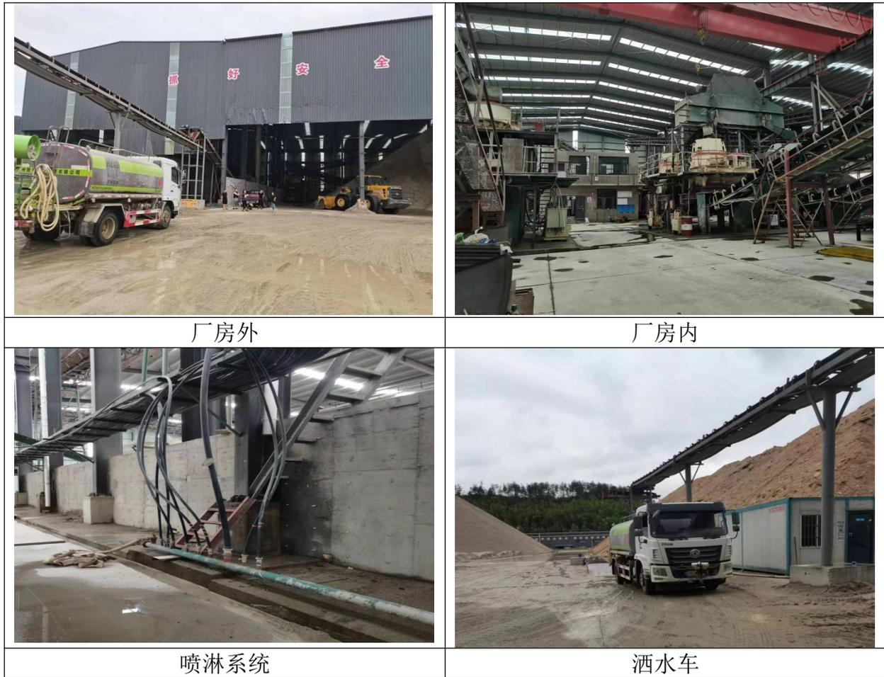
图 3-3 废气产污节点和处理设施
