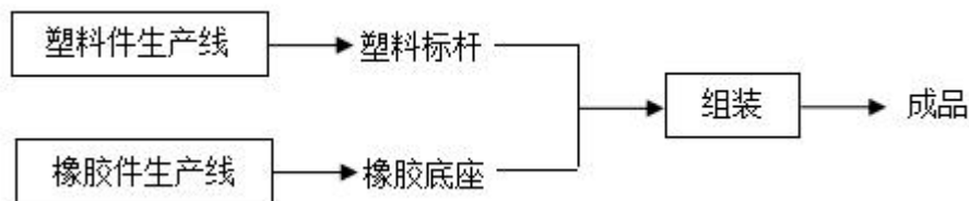
图 3-4 分道标工艺流程图
