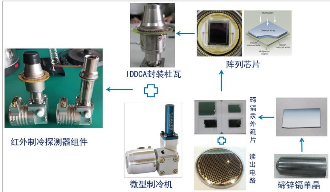
图 3-3 总体工艺流程图
