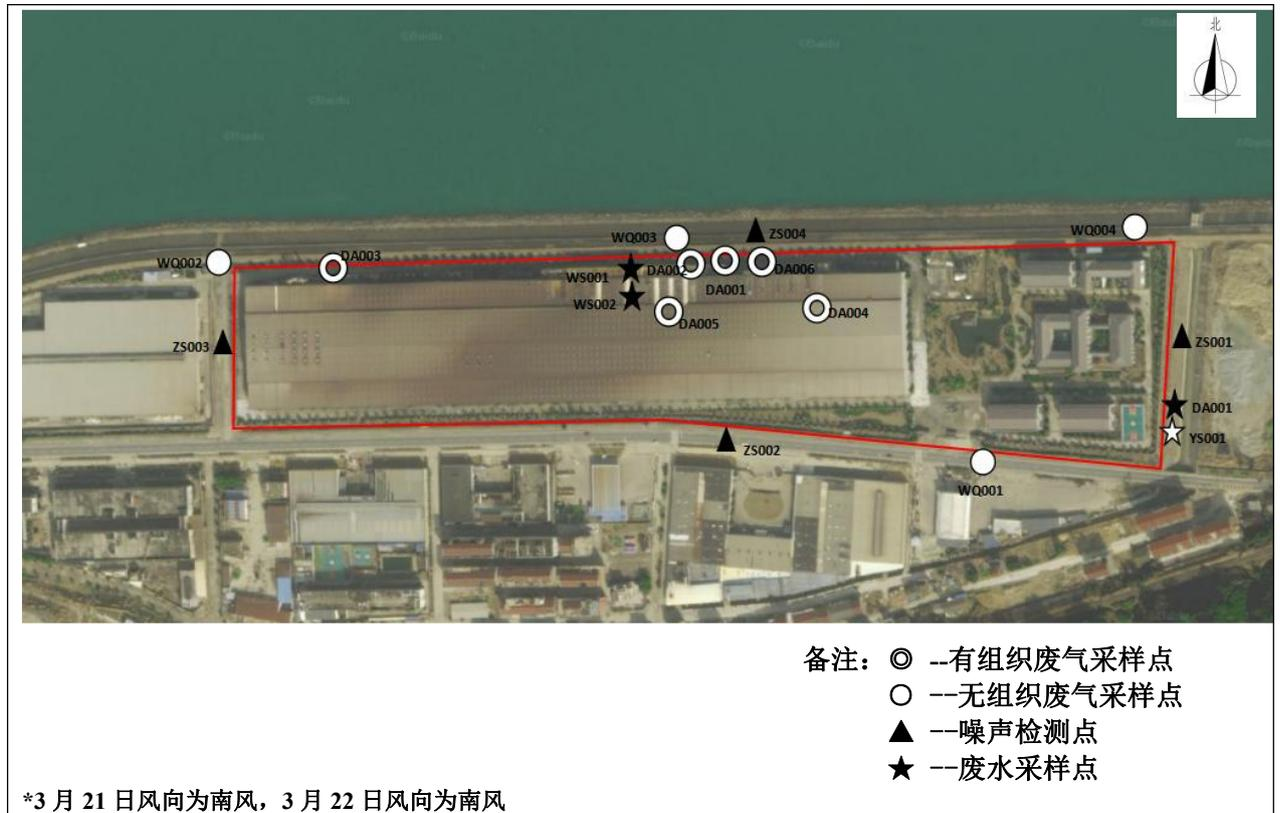
图 3-9 废水、废气、噪声监测点位示意图
