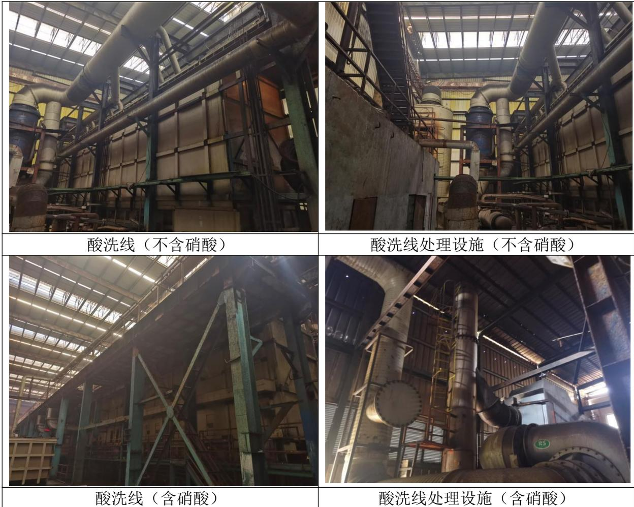
图 3-3 酸洗废气产污节点和处理设施
