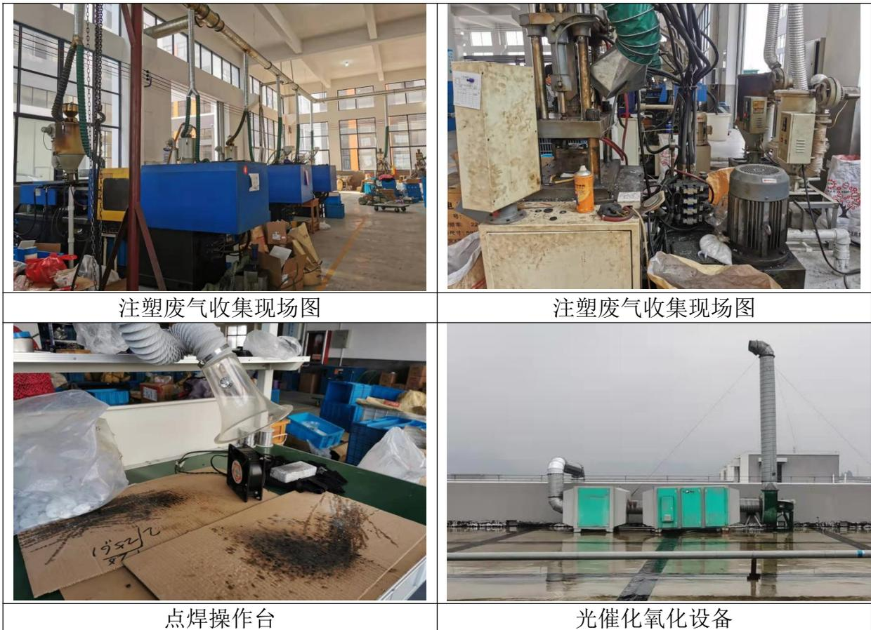
图 3-3 废气收集处理现场图
