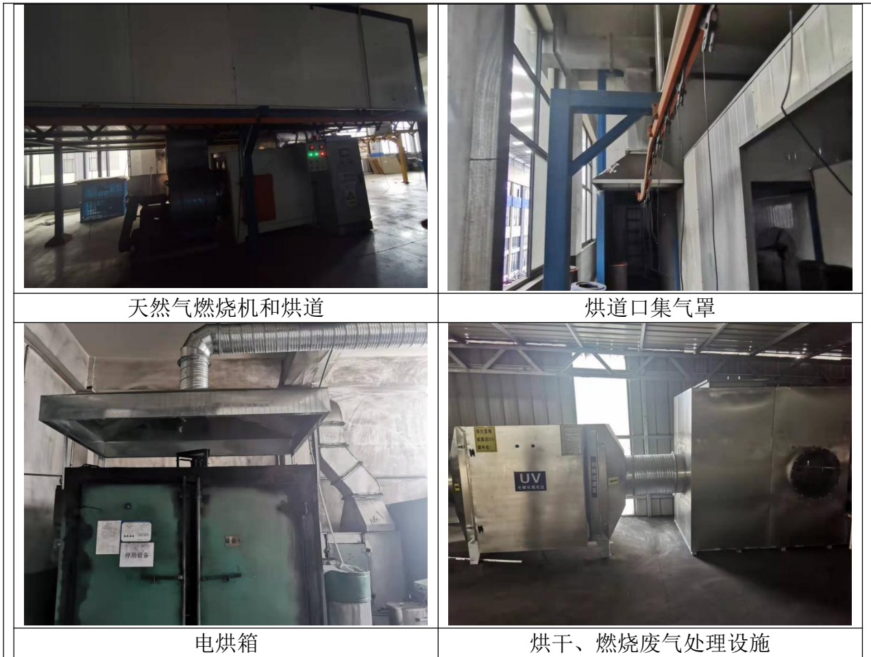
图 3-5 烘干、燃烧废气产污节点和处理设施
