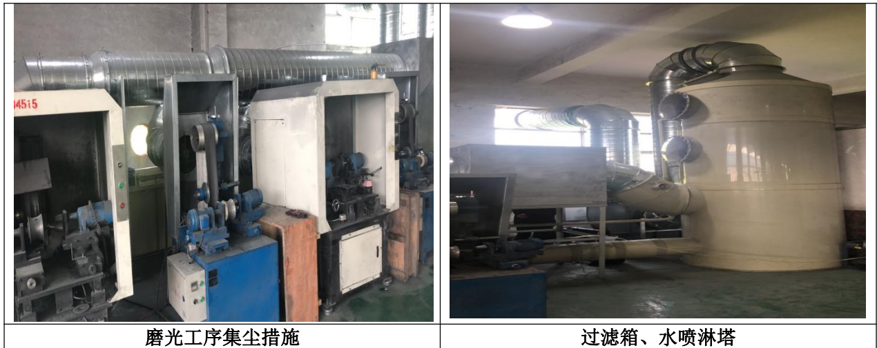
图 4-2 项目磨光粉尘治理流程
