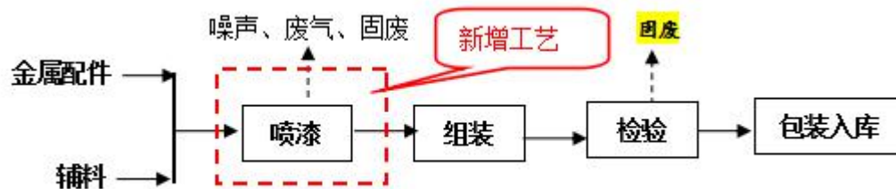
图 3-5 气动执行器生产工艺流程及产污流程图
